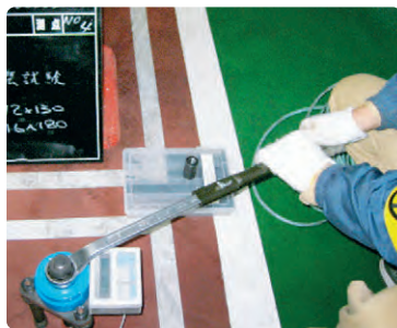
アンカー強度の確認
