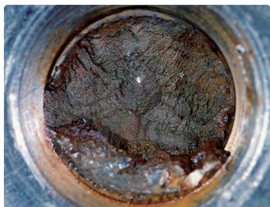
ステンレス鋼材の 応力腐食割れ破断面の例
